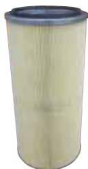
Patronenfilter Feinfiltration durch selbst-reinigenden Filterpatronen erhöht Intervall zw. erforderlichen Filtertauschen. (Normale Lebenszeit 2000-6000 Stunden.)
