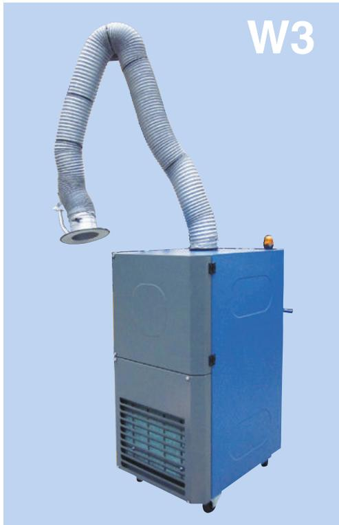
Effiziente und mobile Filtereinheit mit automatischer Druckluftreinigung mit integriertem Ventilator, die zur Filterung von Luft aus Prozeßen angewandt wird, die begrenzte Staubmengen (Schweißen, Schneiden, Schleif u.a.) bilden.
