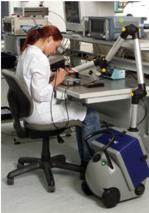
Handlöt-Arbeitsplatz mit Absaug- und Filtertechnologie
