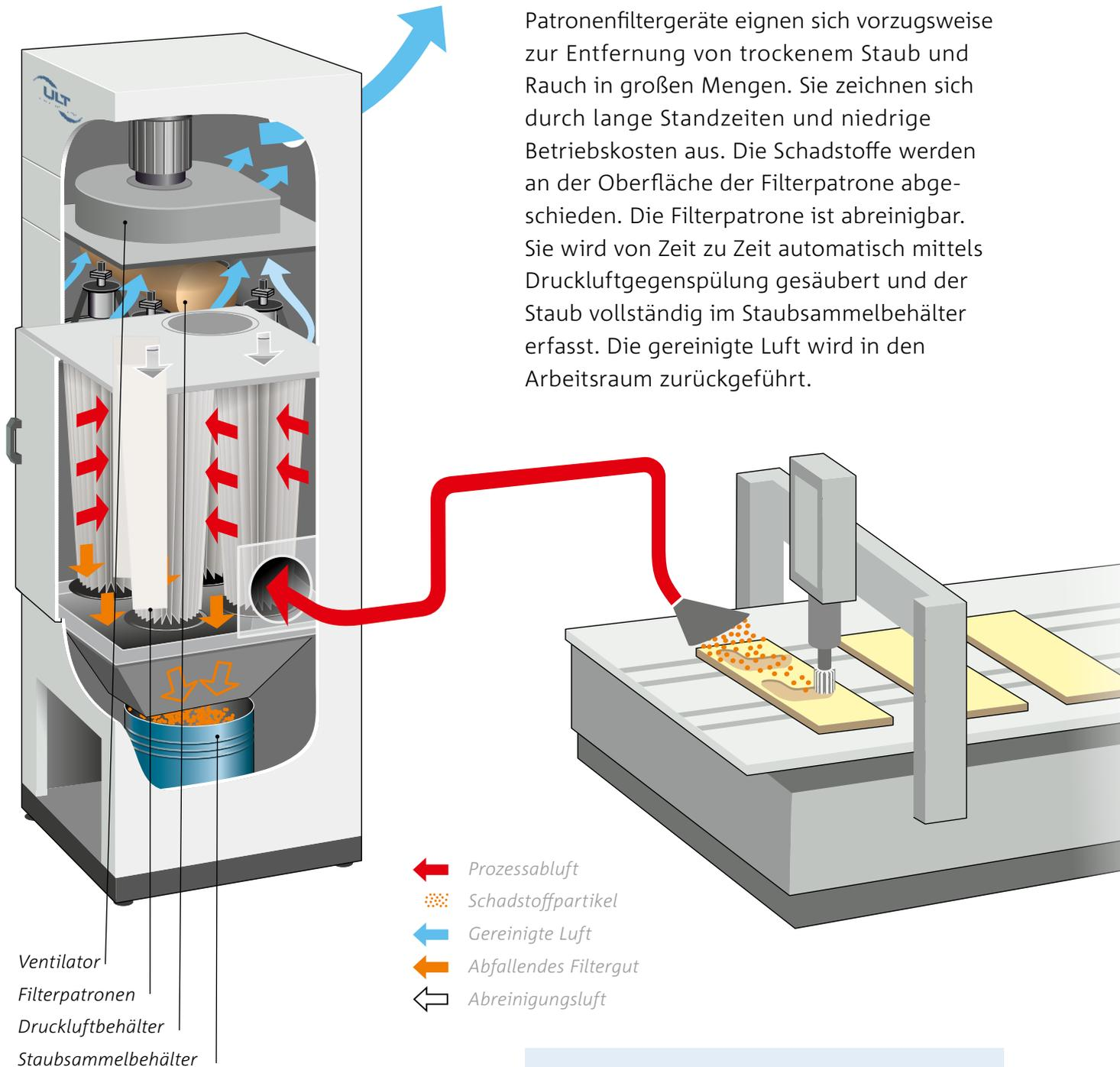
Funktionsprinzip eines Patronenfiltergerätes ASD
