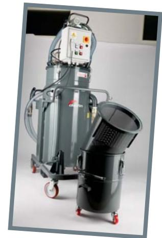
Separator, fahrbarer Spänebehälter mit integriertem Spänekorb. Leicht zu Entkoppeln ohne Öl Leckagen.
