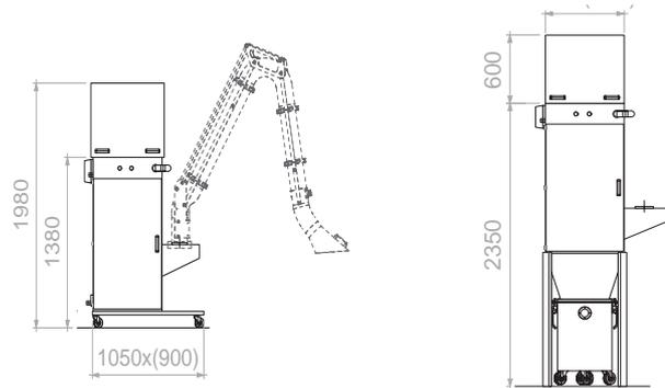
Varianten: mobile oder stationäre Ausführung möglich
