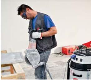
Option: Einschaltautomatik für Elektrowerkzeuge
