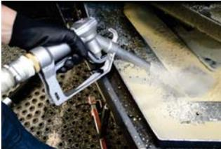
schnelle Entleerung der Flüssigkeit über Volumenstrom-Umkehrventil
