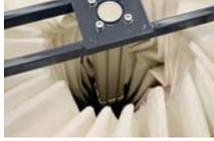
Filterabreinigungssystem mit eingebautem Kompressor
