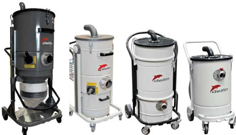
Filter-Vorabscheider-Systeme für Flüssigkeiten und feste Medien für 300-600 m/h Saugleistung
