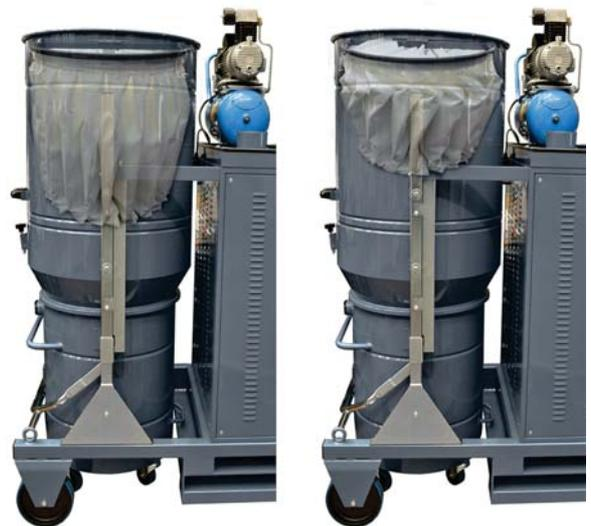
effiziente vertikale Filterabreinigung
