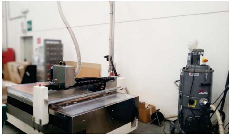
Die Industriesauger der Zefiro-Serie sind mit einem wartungsfreien Seitenkanalverdichter ausgestattet, der für den Dauerbetrieb (24 Std /Tag) konzipiert ist.
